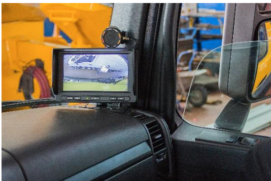
Assistenzsysteme: Toter-Winkel- und Abbiegeassistent
