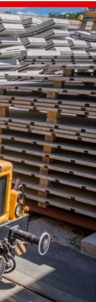
Ein wesentliches Kriterium ist hierbei die Präzision des Endprodukts, des Tübbingrings. Bei Genauigkeiten von  $\pm 0,3$  mm sind Produktionsanlagen, handwerkliche Fähigkeiten und Ingenieurleistungen in Planung und Abwicklung täglich auf höchstem Niveau gefordert.
